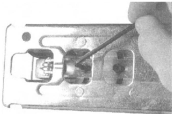
Odpojte zariadenie zo zásuvky vytiahnutím zástrčky zariadenia. Zdvihnite bezpečnostný kryt a odskrutkujte skrutku pomocou vhodného kľúča na spodnej časti zariadenia.
